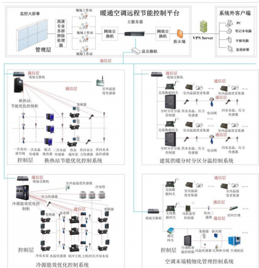
图 4-7-1 暖通空调远程节能控制平台架构（图源：《中国石油大学（华东）暖通节能控制系统介绍》）
