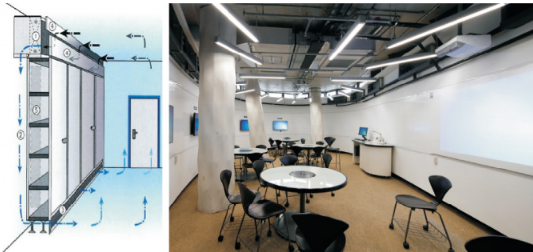
图 3-1-3 学习室置换通风分析和室内照片（图源：新加坡高等教育机构绿色校园建设研究）
