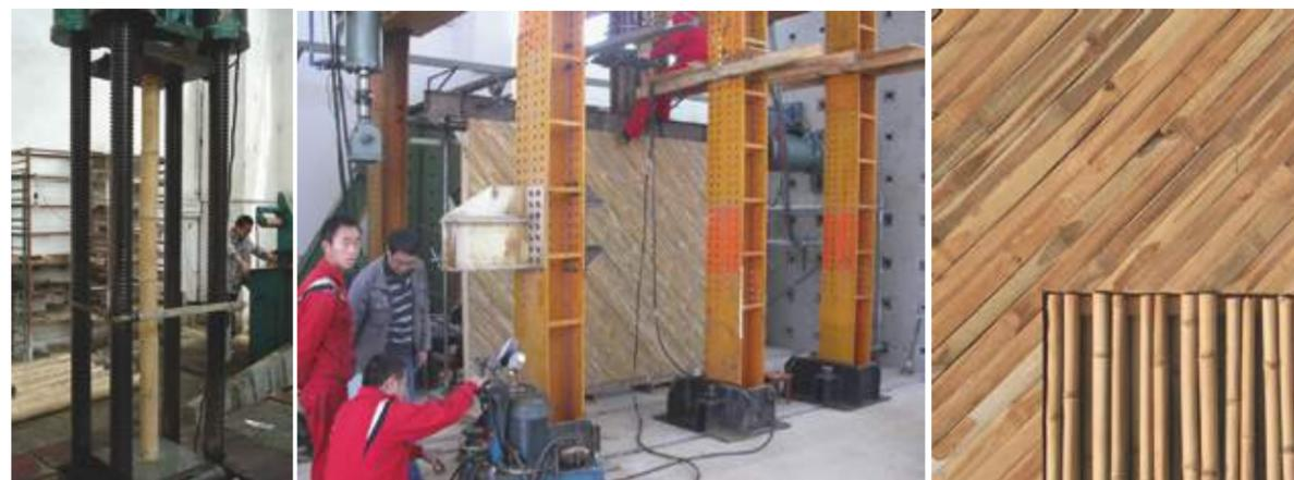
组图：原竹加工成竹墙板后，云南省工程抗震研究所对原竹抗震墙进行竖向承载力实验和抗震实验。
